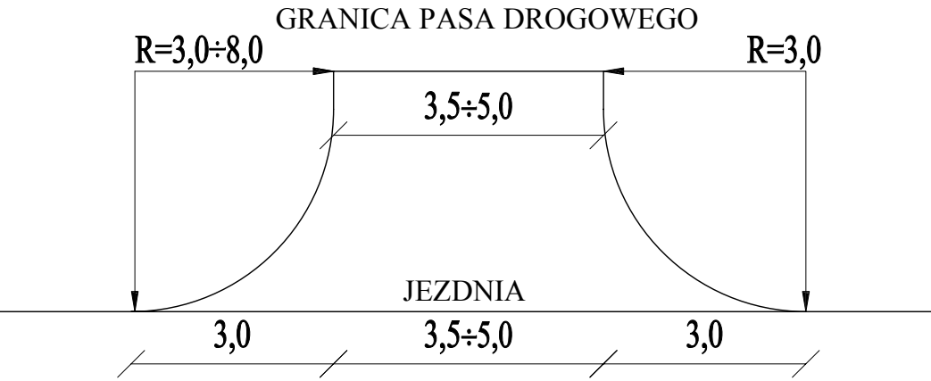
SZCZEGÓŁ KONSTRUKCJI WJAZDÓW NA DROGI ZBIORCZE SKALA 1 : 100
